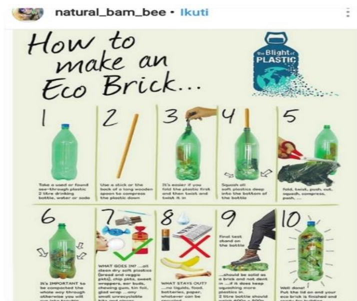
Gambar 2.2 Langkah-Langkah Membuat Ecobrick
