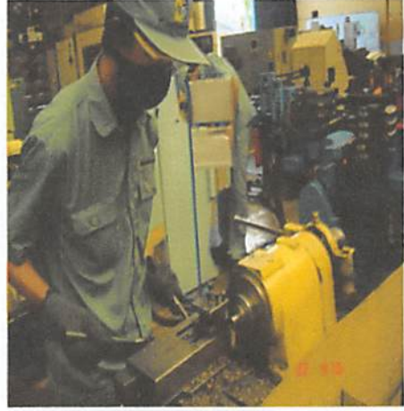
Proses Slotting (pembentukan profil di kedua sisi material )
