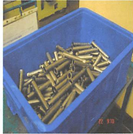
Produk pipe stand maind pivot no. prod 159 sebelum proses flating
