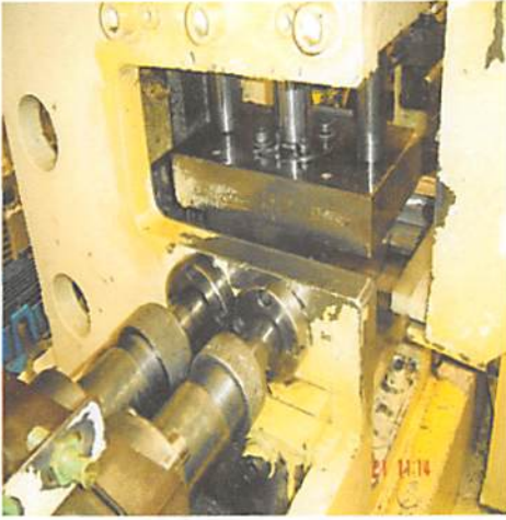
Proses Hemming dan pemberian merk "S" pembentukan profil (pengepengan)
